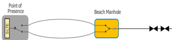
**Figure 5 : V Node protection scheme**
