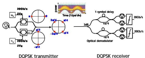
Fig 5 : DQPSK transmitter and receiver
